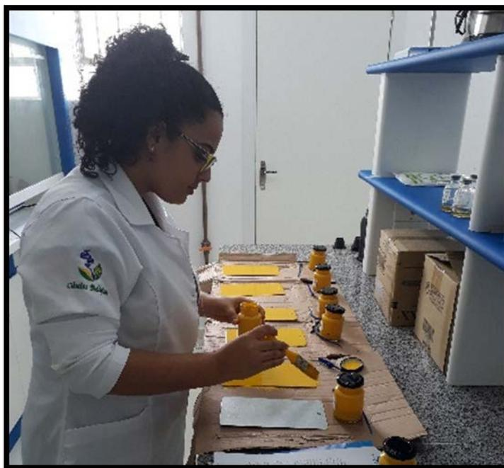
**Figura 3.** Preparo das placas de aço galvanizado com as tintas preparadas.
