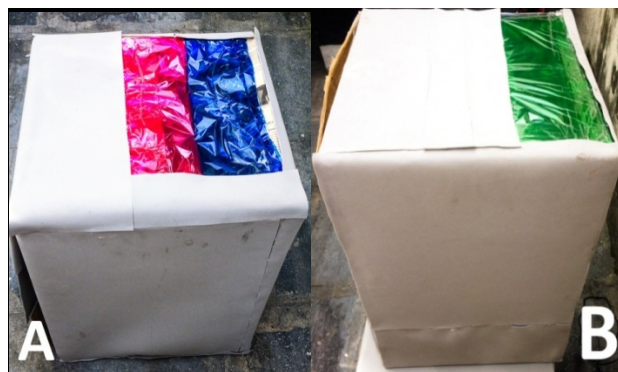
Figura 7. A- Caixa elaborada para o experimento de efeito de luz azul e vermelho. B- Caixa elaborada para o experimento de efeito de luz verde. Fonte: Dados da pesquisa, 2019.
